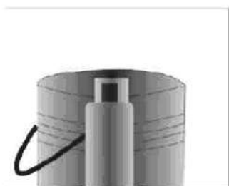
Наполнение системы теплоносителем при помощи погружного насоса
