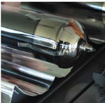
газопоглотитель в порядке, трубка исправная
