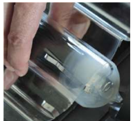
газопоглотитель разрушен, трубка неисправная
