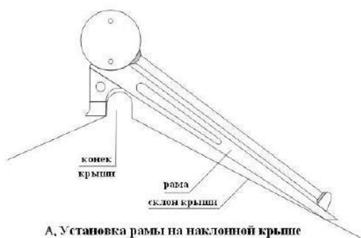
А. Установка рамы на наклонной крыше
